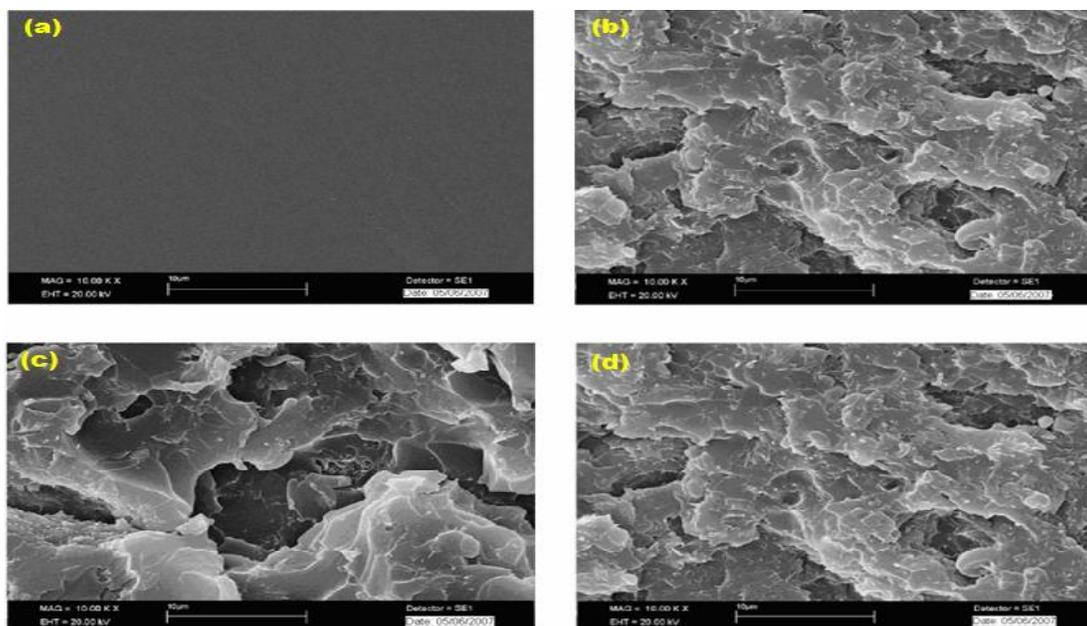
**Figure 8.** SEM photograph of (a) neat epoxy (b) 2 wt. % CB (c) 3 wt. % CB (d) 4 wt. % CB
